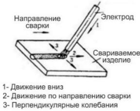
Рисунок 13.4 Три основных направления движения электрода
